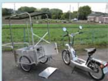
写真（田村プロジェクト） ソーラーパネル、コントローラー、バッテリーを 設置したアルミ折りたたみ式リヤカー（右） 非常用電源として電動バイクを充電中（左）
